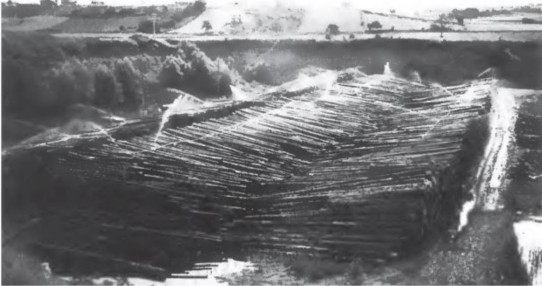
Figure 1 : Photographie dispositif tête-bêche pour aspersion en grande longueur tirée de "La conservation des bois ronds par voie humide" J. BAYLOT, D. DIROL, P. VAUTHERIN
